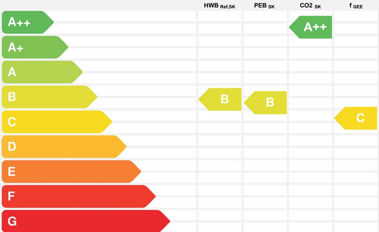
**HWB<sub>Ref</sub>:** Der **Referenz-Heizwärmebedarf** ist jene Wärmemenge, die in den Räumen bereitgestellt werden muss, um diese auf einer normativ geforderten Raumtemperatur, ohne Berücksichtigung allfälliger Erträge aus Wärmerückgewinnung, zu halten.
