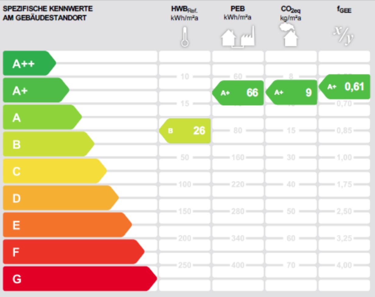
**HWB<sub>Ref.</sub>:** Der Referenz-Heizwärmeverbrauch ist jene Wärmemenge, die in den Räumen bereitgestellt werden muss, um diese auf einer normal geforderten Raumtemperatur zu halten. Dabei werden etwaige Erträge aus Wärmeergänzung raumlufttechnischer Anlage nicht berücksichtigt.
