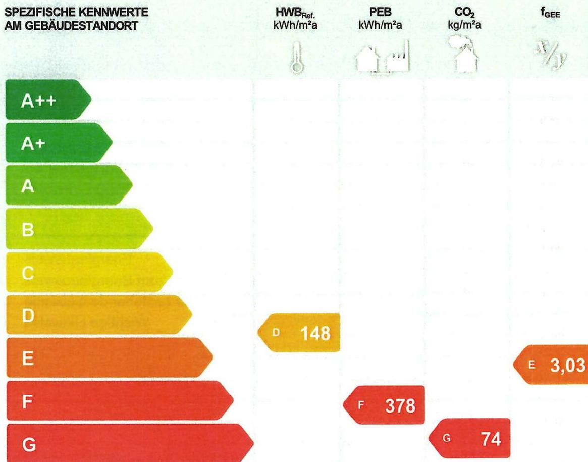
**HWB<sub>Ref.</sub>:** Der **Referenz-Heizwärmebedarf** beschreibt jene Wärmemenge, die in einem Raum bereitgestellt werden muss, um diesen auf einer normativ geforderten Raumtemperatur (bei Wohngebäude 20°C) halten zu können. Dabei werden etwaige Erträge aus Wärmerückgewinnung bei vorhandener raumlufttechnischer Anlage nicht berücksichtigt.
